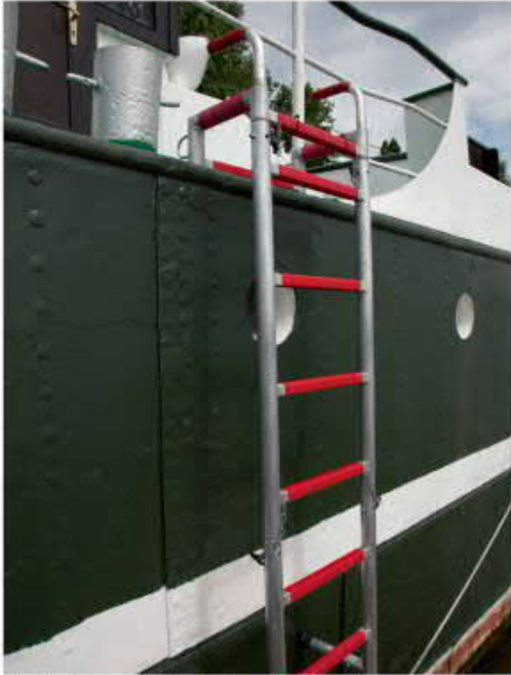
Für die Binnenschifffahrt: Leiter mit eckigen Haken
